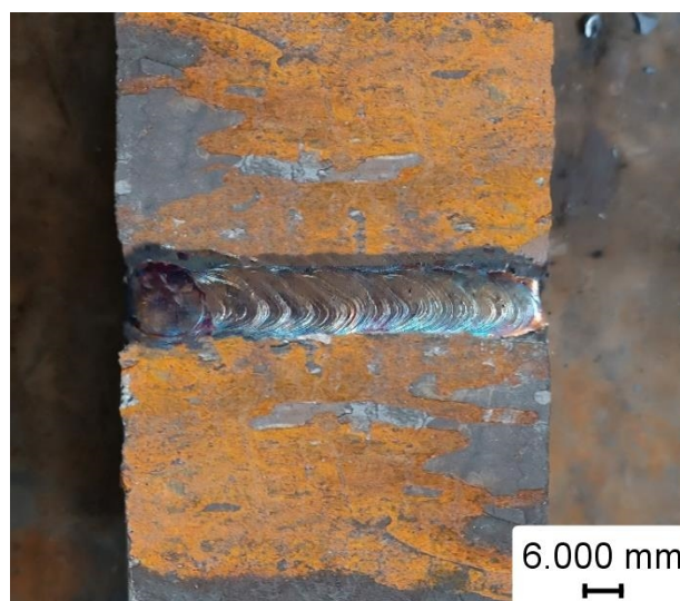
شکل 11- نمای جوش ایجاد شده در ناحیه اتصال قطعات مورد مطالعه.
